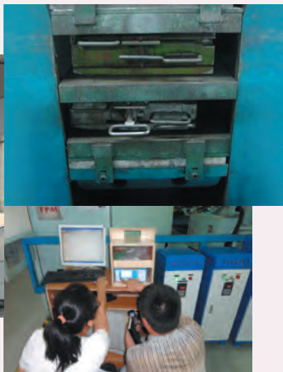
二次發泡注入機上安裝綠色伺服器
